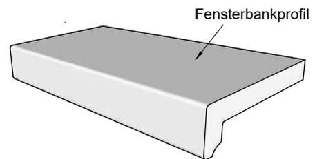
Die Breite der rückseitigen Eckausschnitte rechts bzw. links, z.B. 4 cm oder auch breiter ist frei wählbar, Zuschnitt im Werk oder vor Ort durch den Monteur
