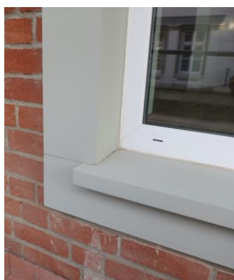
SLB 155 Fensterbank mit Ansichtshöhe 15 cm, bestehend aus einem oberen Profil mit seitlichen Abschlüssen sowie einem mit dem Profil verklebten Untersims. Profil mit ausgeprägter Tropfkante | passend zu Winkelgewände SLG 150
