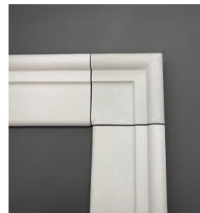
Separate Formteile 11,5 x 11,5 cm für die Eckausbildung können anstelle von Gehrungen verwendet werden
