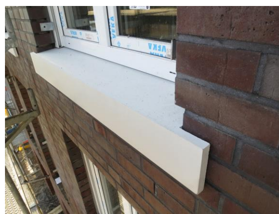
SLB 150 Fensterbank mit Ansichtshöhe 15 cm und rückseitigen seitlichen Ausklinkungen jeweils 13 cm passend zu Winkelgewände SLG 150
