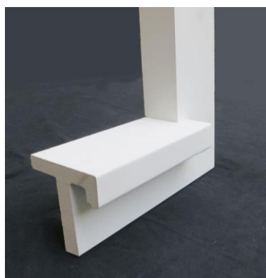
SLB 155 Fensterbank mit Ansichtshöhe 15 cm, bestehend aus einem oberen Profil mit seitlichen Abschlüssen sowie einem mit dem Profil verklebten Untersims. Profil mit ausgeprägter Tropfkante | passend zu Winkelgewände SLG 150
