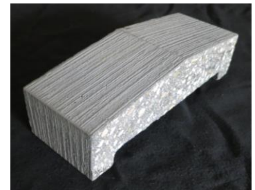
Schnitt durch MAD / MPU Satteldach
