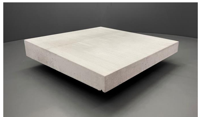
MAP Mauerabdeckung Pultdach mit fein-scharrierter Oberfläche, mit unterseitiger Tropfkante an einer Längsseite
