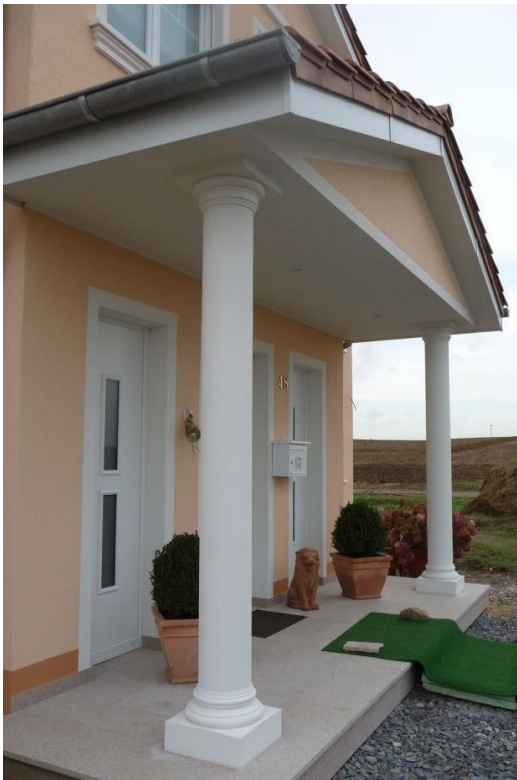
Hohlsäule 11111-25 mit A1 Abakusplatte + K1 Kapitell Serlio + S1 Schaft + B1 Basis Serlio + P1 Plinthe
